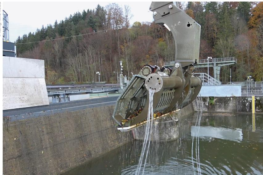
**Bild 4:** Rechenreinigung am Kraftwerk Altusried
