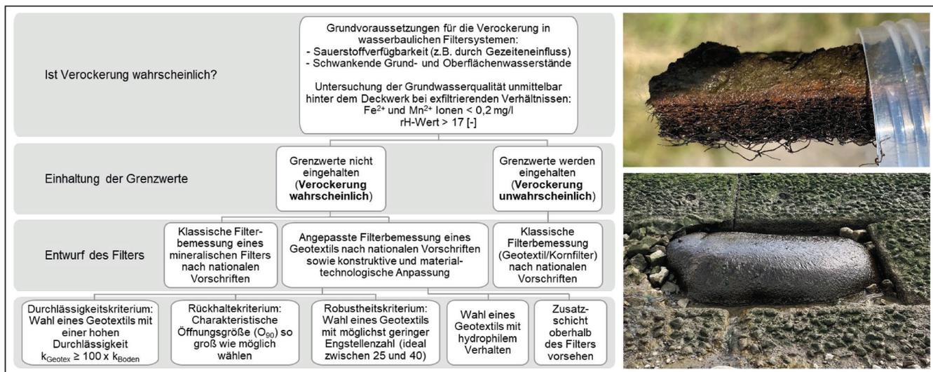
**Bild 1:** Vorschlag für ein Verfahren zur Bewertung der Verockerungsneigung und Filterdimensionierung
